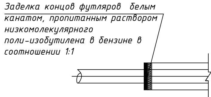
Узел заделки между трубой и футляром
